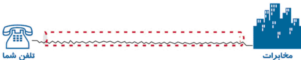
شکل ۱ - لوله ی پهنای باند زوج سیم تلفن
